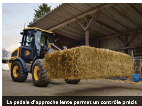
La pédale d'approche lente permet un contrôle précis
