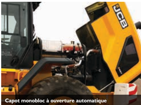
Capot monobloc à ouverture automatique
