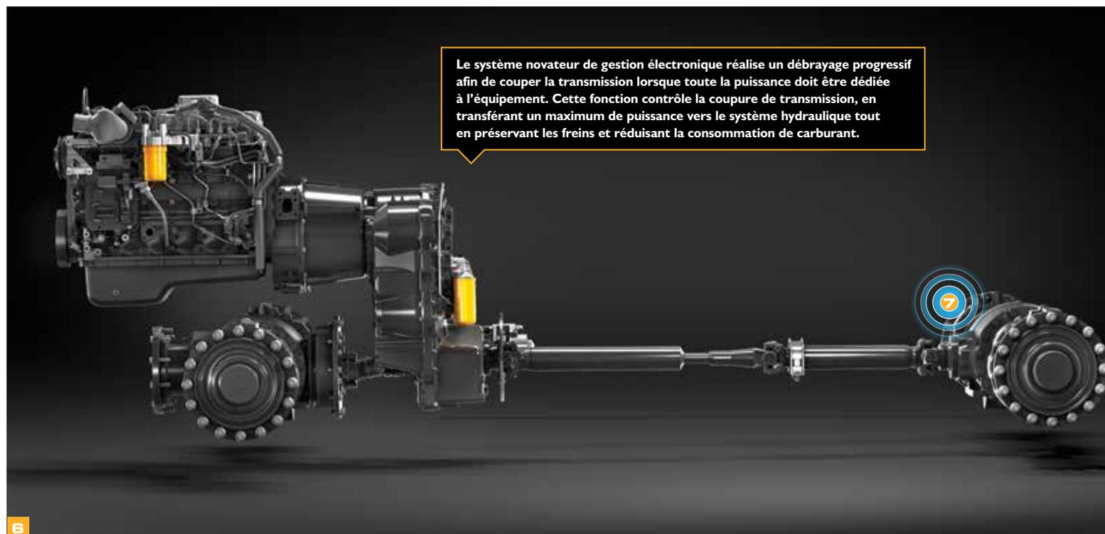
Le système novateur de gestion électronique réalise un débrayage progressif afin de couper la transmission lorsque toute la puissance doit être dédiée à l'équipement. Cette fonction contrôle la coupure de transmission, en transférant un maximum de puissance vers le système hydraulique tout en préservant les freins et réduisant la consommation de carburant.
