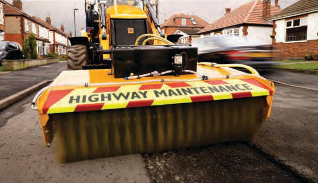
4. **BALAYAGE** | La balayeuse avec bac de ramassage permet de ramasser tous les débris, grains de poussière et traces d'eau.
