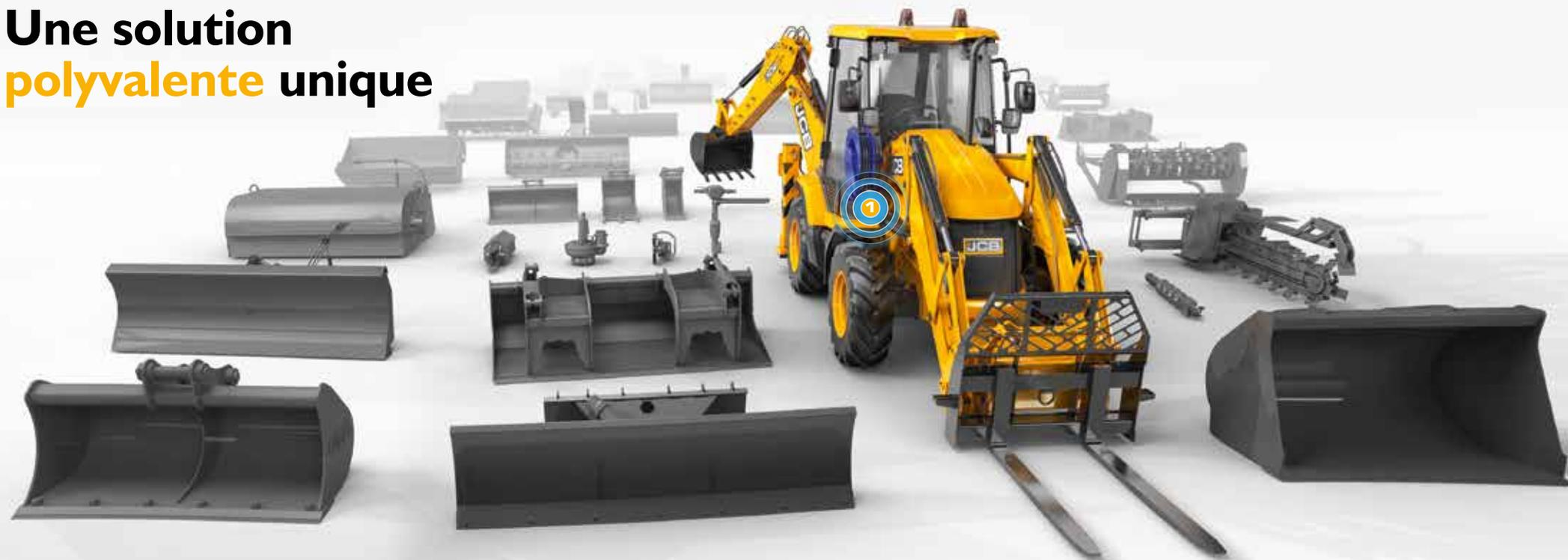
**1** La JCB 3CX COMPACT n'est pas uniquement compatible avec la vaste gamme d'équipements pour chargeuses-pelleteuses. Elle a également la possibilité d'utiliser une vaste gamme d'équipements pour chargeur compact. Une ligne bidirectionnelle et un circuit d'outils à main apportent une plus grande polyvalence.
