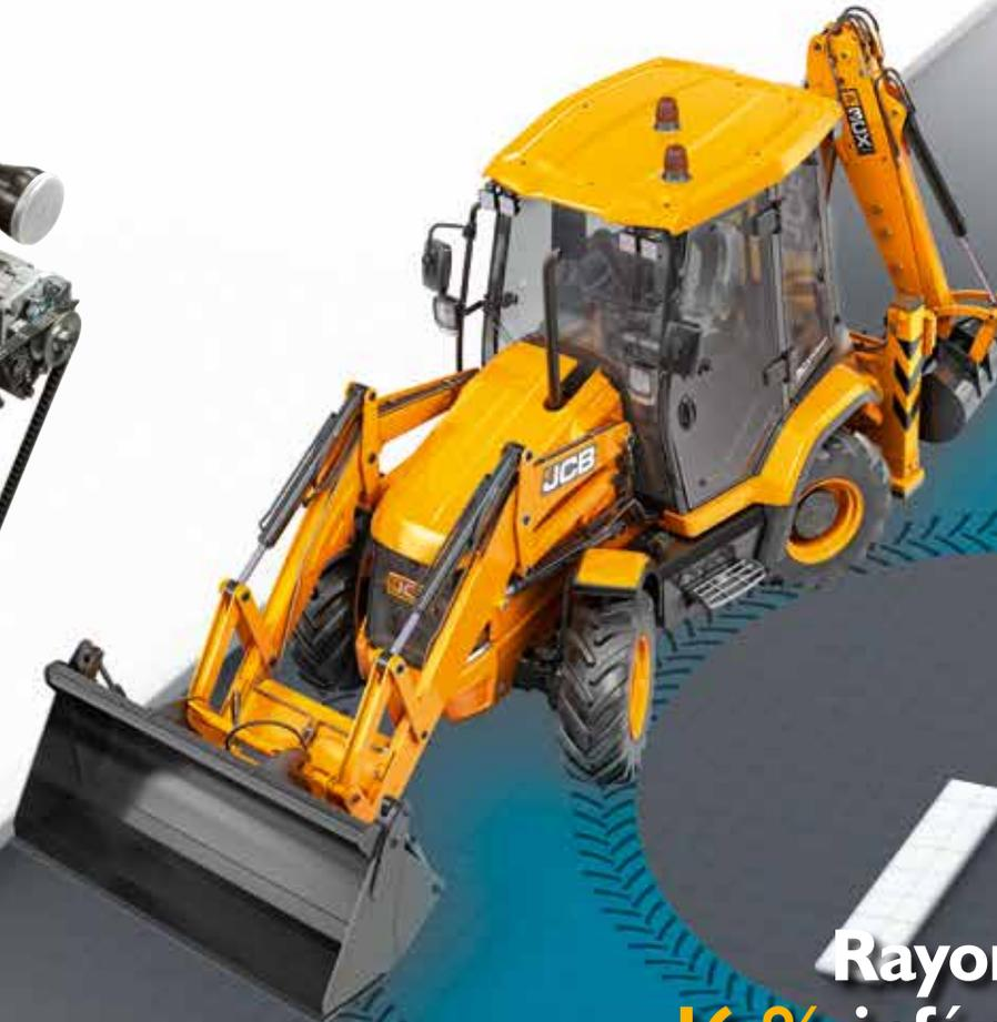
Grâce à l'incroyable rayon de braquage de 5,8 m (avec freins serrés), la machine peut tourner complètement à 180 degrés sur une seule voie.
