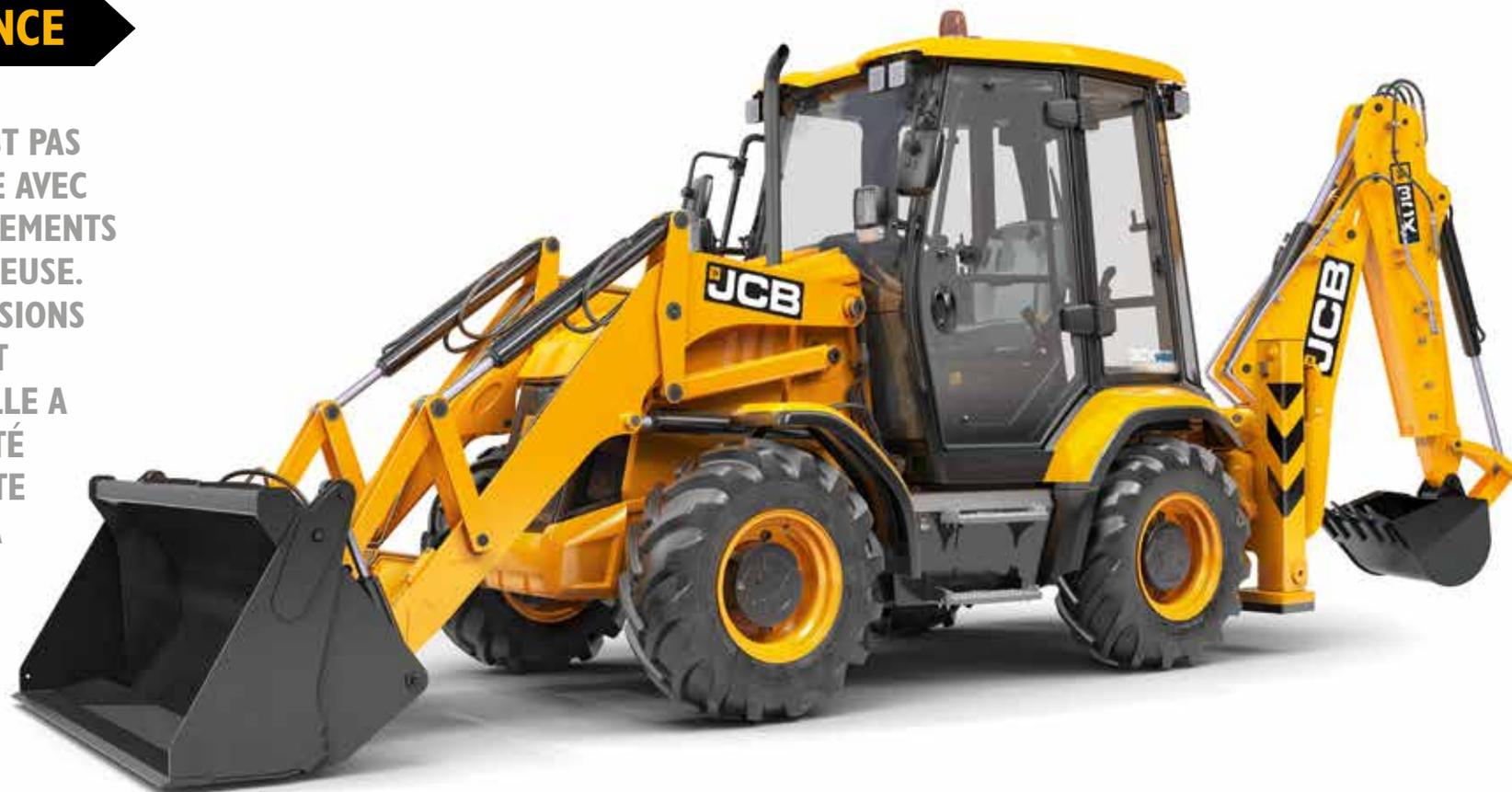
Machine trois-en-un, la JCB 3CX COMPACT combine les fonctions d'une mini-pelle et d'une chargeuse sur pneumatiques, avec la polyvalence offerte par les équipements pour chargeur compact.
